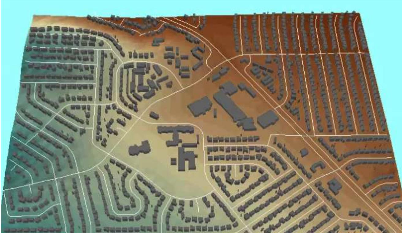
Integrierte Betrachtung von Abflusskonzentration, Kanalnetz und Oberflächenhydraulik
